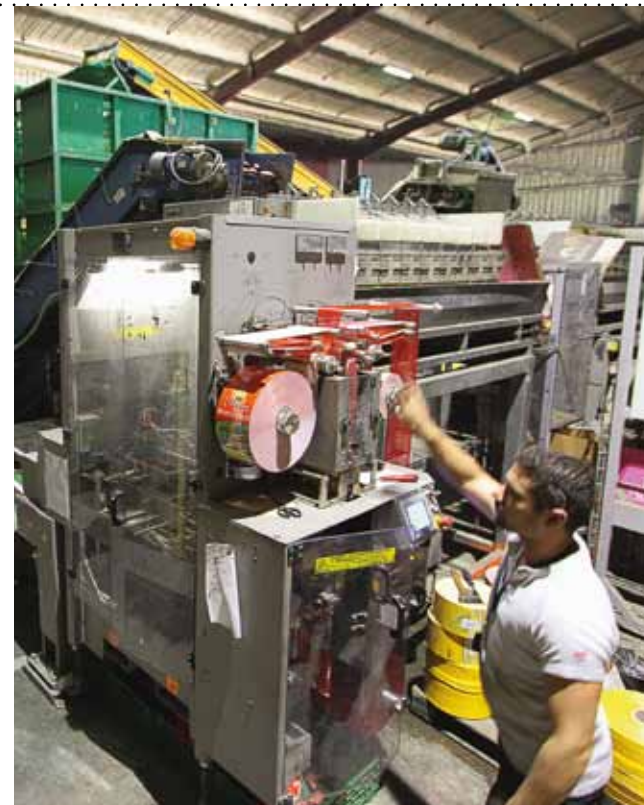
La mise en sachets clôture les opérations de lavage et de calibrage. Chez Solédy (Saint-Flavy), un robot de manutention, unique dans la région, réduit la pénibilité pour les salariés en bout de chaîne.
