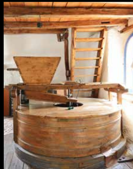
SAINT-MARTIN-DE-BOSSEY. Si la fin de l'activité a sonné vers 1950 pour ce moulin, il a conservé son bief, sa roue à aubes, ses meules et sa trémie, dans laquelle on versait le grain.
