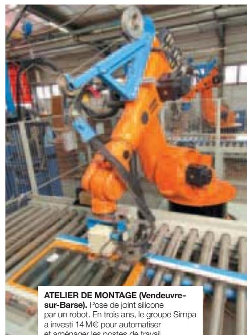
**ATELIER DE MONTAGE (Vendevre-sur-Barse).** Pose de joint silicone par un robot. En trois ans, le groupe Simpa a investi 14 M€ pour automatiser et aménager les postes de travail.
