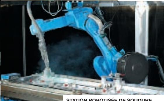
**STATION ROBOTISÉE DE SOUDURE SUR ALUMINIUM.** Larbaletier s'en est doté
