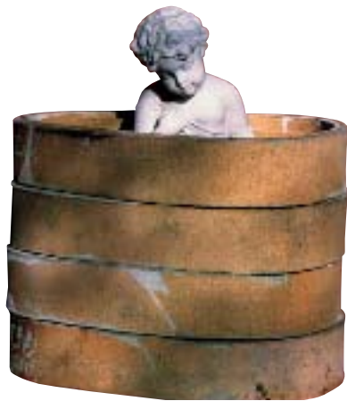
BISCUIT DE PORCELAINE encore entouré des "gazettes", ces cylindres creux en argile réfractaire qui le protègent de la souillure des flammes lors de la cuisson dans le four à bois (1960).
